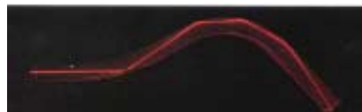
Εικ. 2.11 Η μετάδοση ηλεκτρομαγνητικών κυμάτων στις οπτικές ίνες στηρίζεται στο φαινόμενο της ολικής ανάκλασης.
