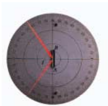
Εικ. 2.7 Διάταξη για την πειραματική μελέτη της ανάκλασης του φωτός.
